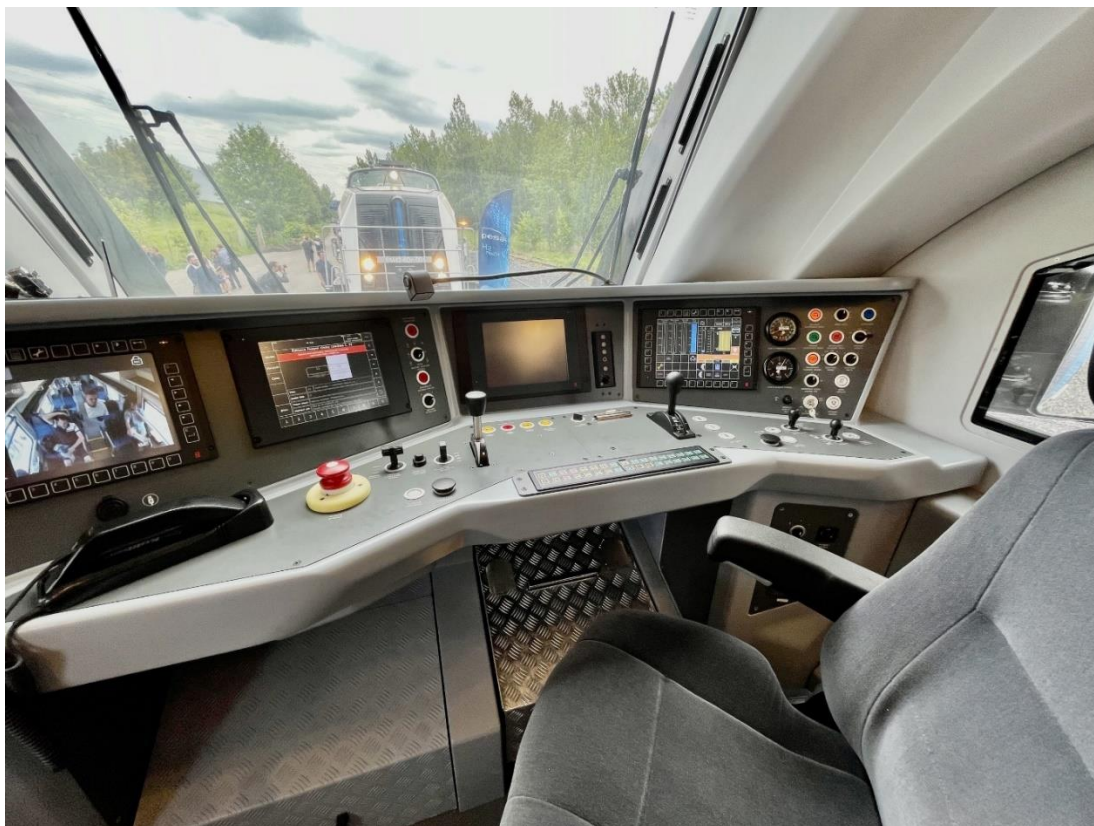
Obr. 4 Stanoviště strojvedoucího jednotky RegioFox (foto: Zdopravy.cz /Vojtěch Očadlý)
