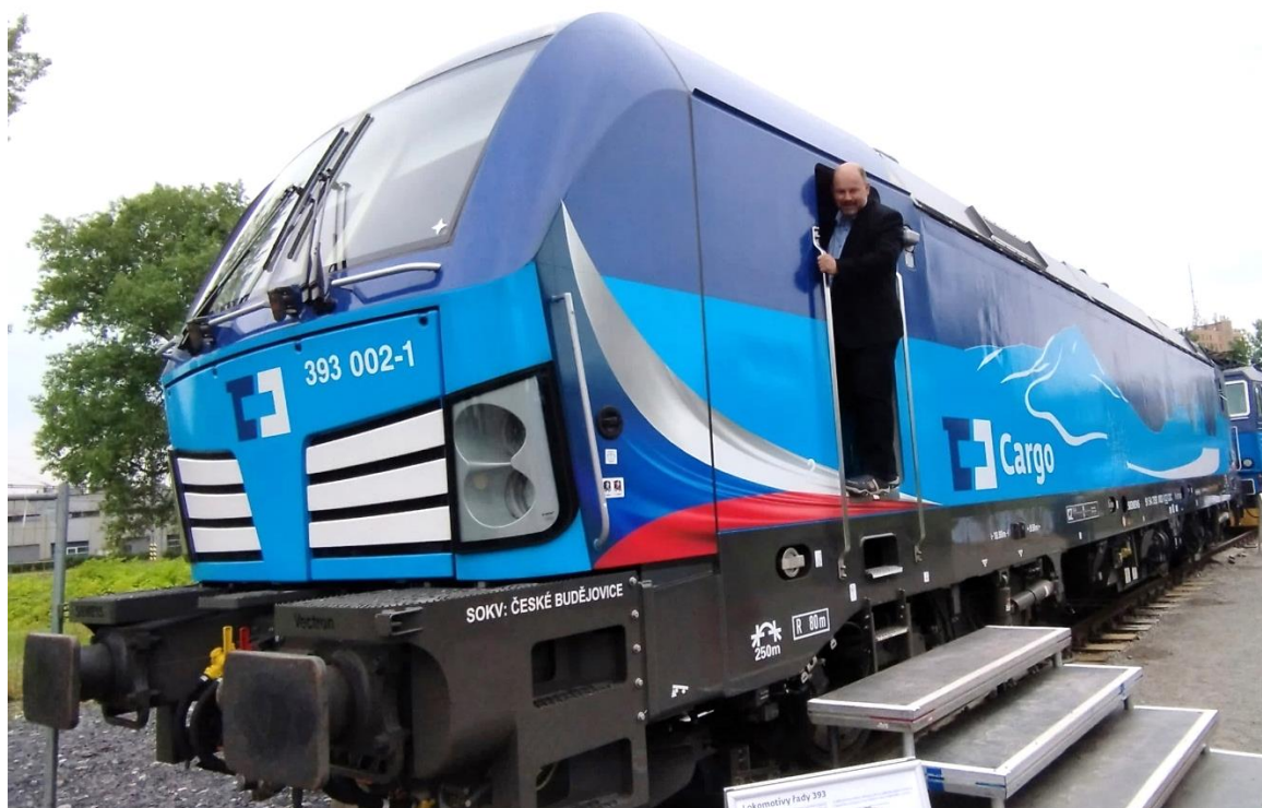
Obr. 6 Lokomotiva Siemens Vectron 393 AC s pomocným dieselovým motorem.
