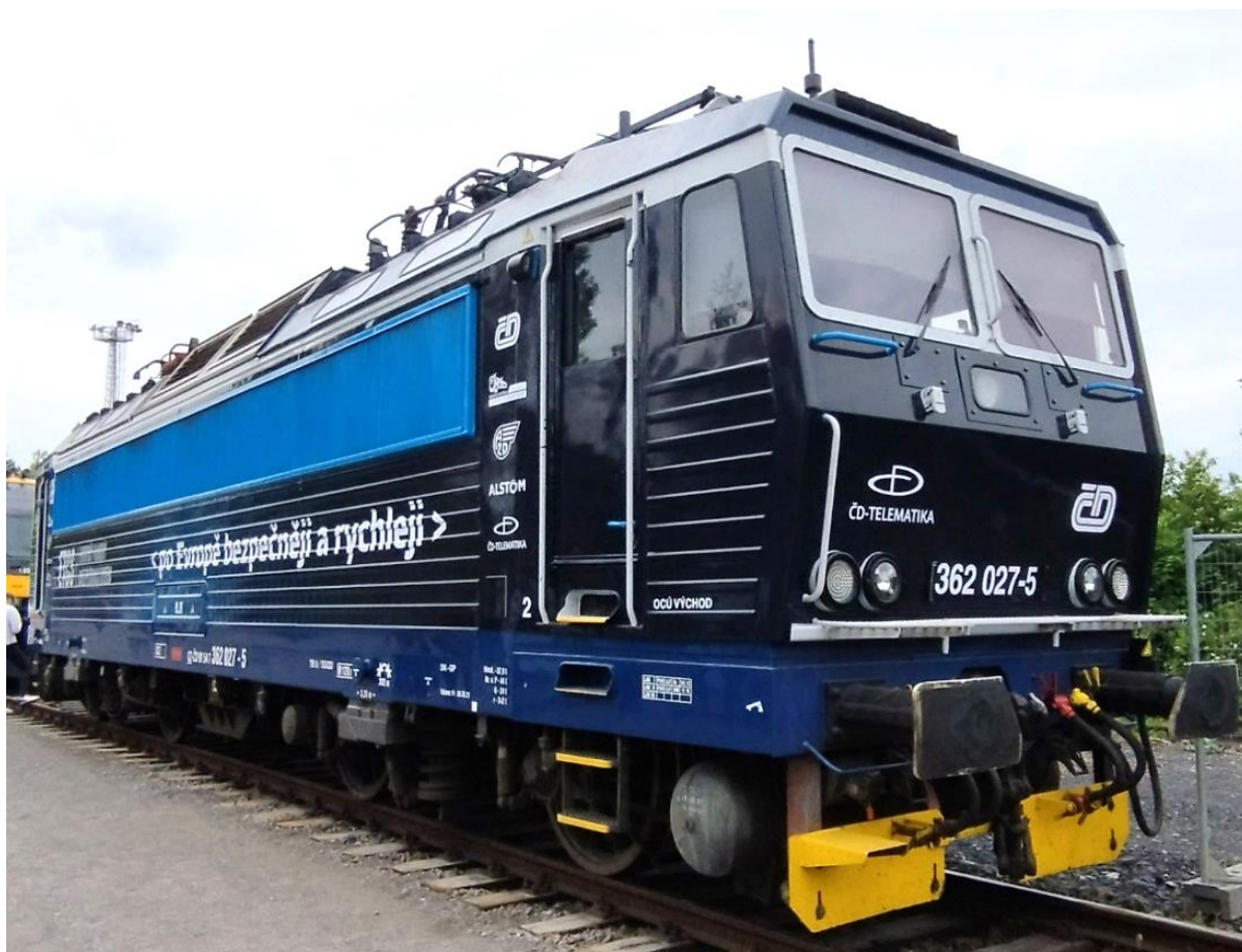
Obr. 7 Lokomotiva 362 Českých drah po instalaci ETCS.
